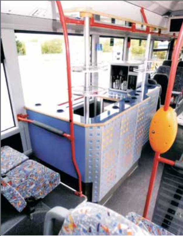
Niederflurküche mit Stehtheke
